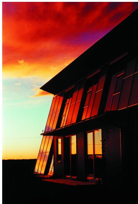
Abb. 6: Aktive und passive Solarenergienutzung ergänzen sich hervorragend. Die passive Solarenergienutzung setzt die Sonnenstrahlung ebenfalls gezielt zur Wärmeengewinnung ein. Allerdings ohne aktive Technik und Regelung. Durch große Öffnungen nach Süden dringt die Sonne im Winter tief in den Raum ein.
